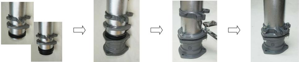
① 管にグリップ、継手フランジロックパッキン（クッションパッキン）の順に装着します。
