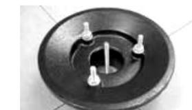
本体の上部にモルタル流入防止用の養生カバーをかぶせ、蝶ナットで締め付け、ドレン本体を固定してください。
